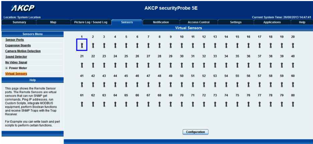
Abb: Sehen Sie hier die 80 virtuellen Sensoren der securityProbe
